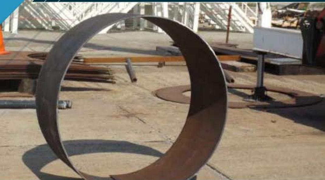
ROLADO DE PLACAS, TUBERÍA Y PERFILES
