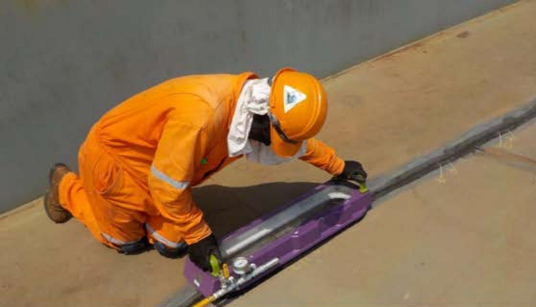
**CAJA DE VACÍO | Inspección de uniones soldadas**
